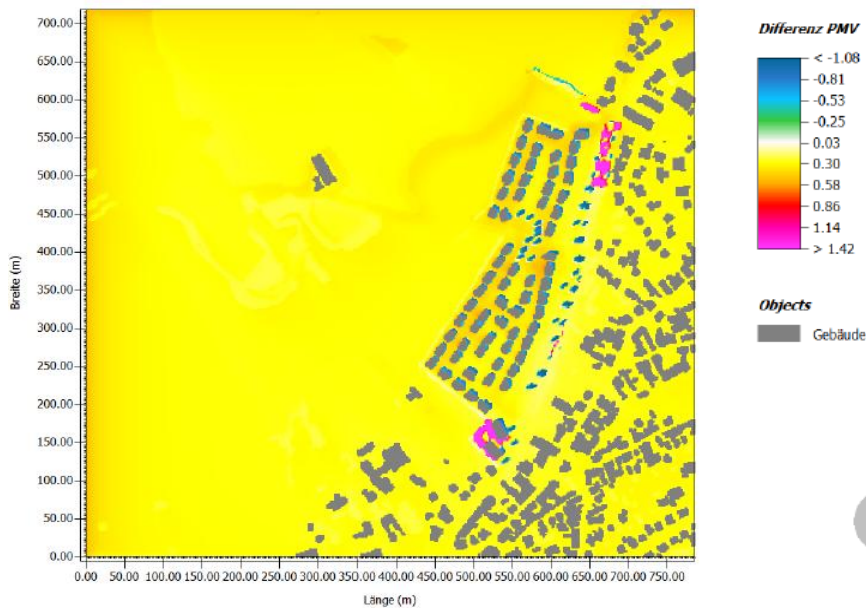
Abb. 37: Differenzanalyse PMV-Werte Plan- und Ist-Zustand am 04.08.2022 - Tagzeitraum
